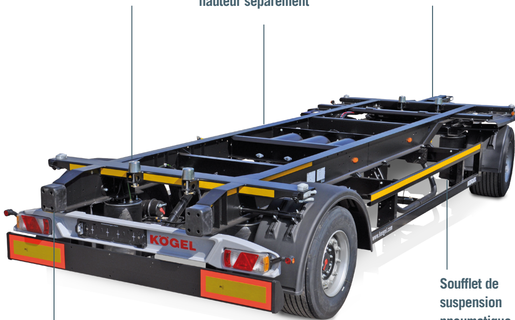
Élément de commande : essieux avant et arrière réglables en hauteur séparément
